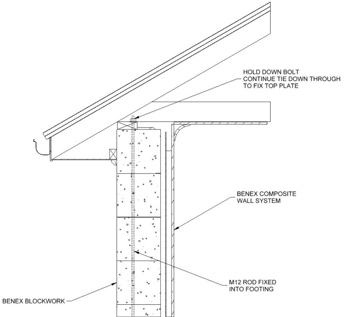
CORE FILLED BLOCKWORK ONLY WHERE REQUIRED BY STRUCTURAL ENGINEER
